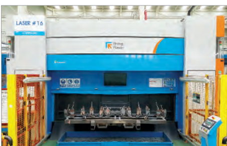
④ 후가공(레이저 커팅) Post-processing(laser cutting)
