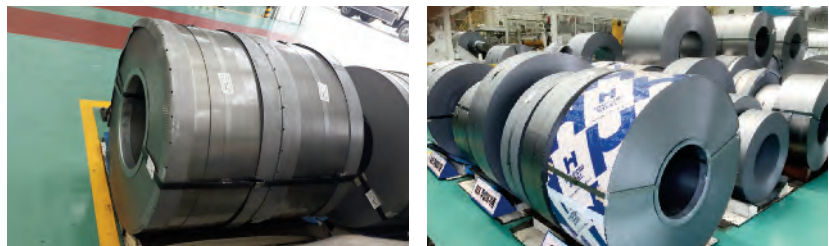
〈 고장력 롤포밍(범퍼) 소재 〉 High Strength Roll Forming(Bumper) Material
