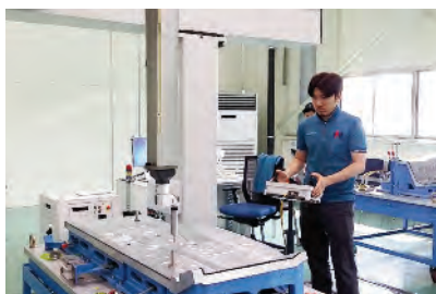
〈 제품 산포도 CMM 측정검사 〉 CMM Measurement of Product Dispersion
