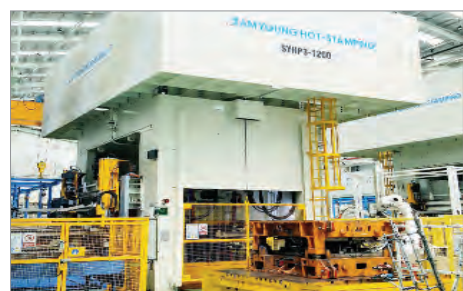
③ 프레스 성형&Quenching Press forming&Quenching
